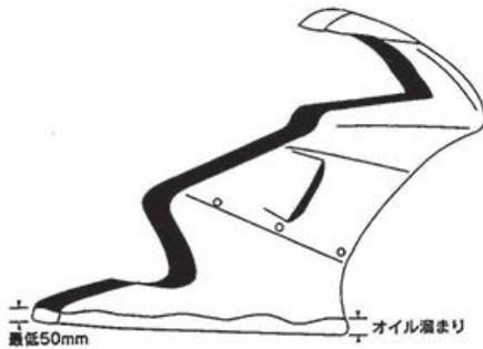
車両の下部フェアリングには、直径20mm（許容範囲+5mm）の穴を1個または2個設けなければならない。
