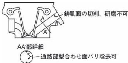
※バリとは、鑄型の合わせ面に生じる「型合わせバリ」を指し、ポート内のザラ付きは、鑄ハダと解釈し、切削、研磨は認められない。
