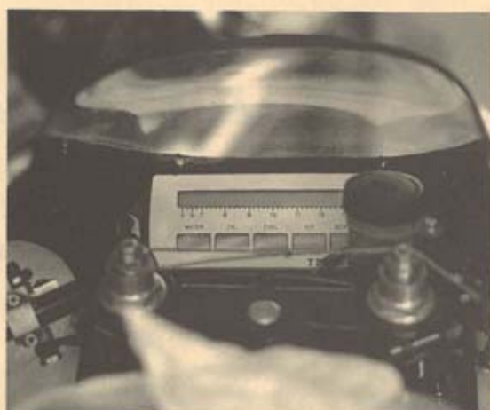
ハンドル・グリップ/レバーとカウリングのクリアランスは20mm以上
